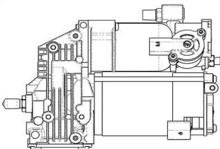
**Название:** Компрессор пневмоподвески для а/м Land Rover Range Rover IV (12-) 3.0d/4.4d (LAS 1004)
