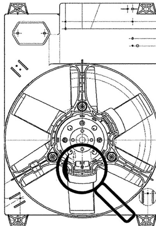
По рабочим характеристикам оба вентилятора являются полными аналогами. Чтобы использовать «левый» вентилятор 3080-1300025 справа или «правый» вентилятор 9080-1300025 слева требуется открутить три гайки крепления, развернуть электродвигатель разъемом в нужную сторону, и снова прикрутить гайки.
