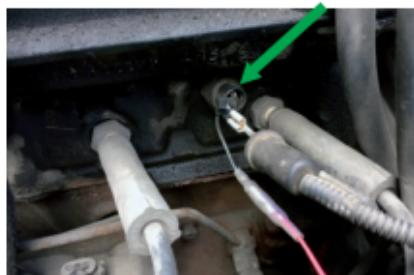
6. Ниже представлен процесс подключения проводов посредством ножевого контактора к вышеперечисленным проводам.
