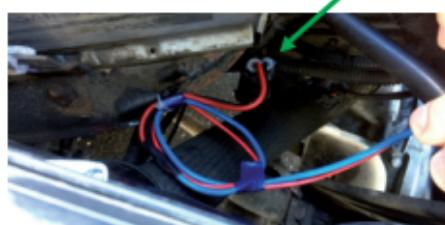
4. Для того, чтобы включить работу блока управления, необходимо его запитать. Мы предлагаем его запитывать от габаритных огней фары. Для этого, необходимо найти провод в штатной системе проводки, который запитывает габаритные огни автомобиля. На фотографии ниже показан вывод питания габаритных огней в разъеме, к проводу к которому мы рекомендуем подключаться. После этого необходимо через ножевой контактор подключить к этому проводу красный провод блока управления меньшего сечения.
