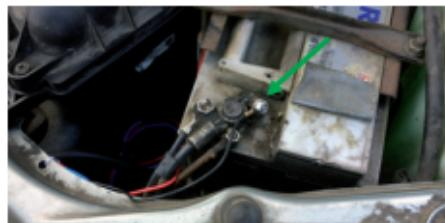
3. Отсоединить разъем электрического вентилятора охлаждения радиатора от штатной системы управления. Подключить разъем блока управления к вентилятору охлаждения.
