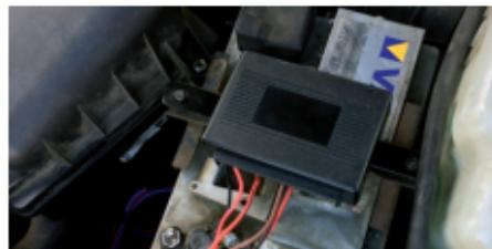
2. Подключить провода с лепестками на концах с отверстием на нем: красный провод к плюсу, черный провод к минусу аккумулятора.
