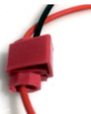
4. Данным разъемом обеспечивается хороший контакт проводов. Обрезать или менять длину проводов запрещено. Может повлечь нарушения в работе блока!
